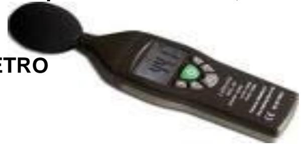
Dopo aver misurato con il fonometro, il livello di rumore delle macchine o delle lavorazioni, si calcola LIVELLO DI ESPOSIZIONE del lavoratore (LEX) che tiene conto anche del tempo di esposizione (giornaliero o settimanale)
