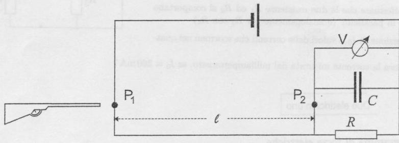
Il proiettile sparato dall'arma da fuoco interrompe il collegamento elettrico prima in  $P_1$  e successivamente in  $P_2$ . Prima che il proiettile sia sparato, il voltmetro misura  $V_i = 12.04 \text{ V}$ ; dopo che entrambi i collegamenti sono stati interrotti, misura  $V_f = 11.53 \text{ V}$ .
