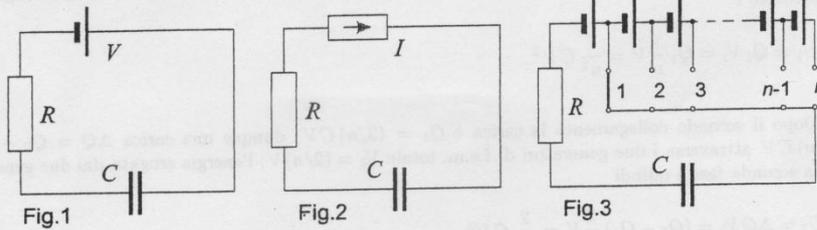
La stessa cosa non sarebbe vera se si utilizzasse un generatore di corrente (fig. 2), ovvero un dispositivo che carica il condensatore fino alla stessa d.d.p.  $V$ , facendo circolare nel circuito una corrente costante  $I$ , per il tempo necessario.
