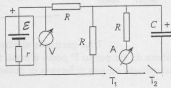
Inizialmente entrambi gli interruttori sono aperti e il voltmetro misura  $V = 48 \text{ V}$ ; dopo aver chiuso l'interruttore  $T_1$  l'ampmetro misura  $I = 1.5 \text{ A}$ .
