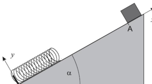
1. Si esprima – scalarmente – la forza risultante agente sul blocco,  $F_R$ , in funzione di  $x$ , sia quando il blocco è staccato dalla molla sia quando è a contatto con essa. Si determini in quale posizione  $x_0$  la forza risultante è nulla. Si tracci un grafico di  $F_R(x)$ .
