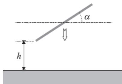
La sbarra viene lasciata cadere senza ruotare e urta il pavimento prima con l'estremità sinistra e poi con quella destra.
