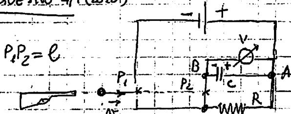
Per misurare in lab. la velocità di un proiettile in tredisse il circuito elettrico in figura, dove  $V$  è un voltmetro,  $R = 1 k\Omega$ ,  $C = 1 \mu F$ ,  $P_1P_2 = l = 100 m$ .
