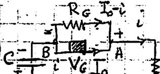
$$R_G \geq \frac{\eta_i R}{1 - \eta_i} = \frac{0,97 \cdot 7,5}{0,03} \Omega = 242,5 \Omega = 243 \Omega$$
